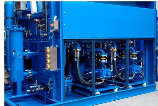
高性能液压系统：刀轴采用液压恒功率变速驱动，具备更广泛的使用范围；
